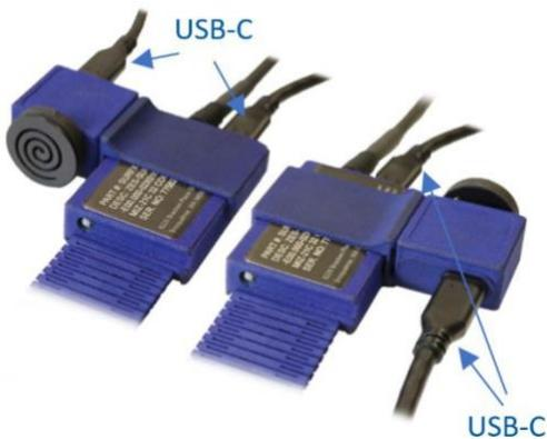
La Polarité de l'encodeur est définie par l'orientation de l'encodeur. Si le connecteur USB-C de l'encodeur se trouve du même côté que le connecteur USB-C du module électronique, la polarité est normale. Si elle se trouve du côté opposé, la polarité est inversée.
