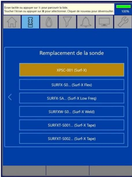
Le numéro de référence de la sonde définit le type de sonde utilisé. Cela permet de déterminer la façon dont les données sont affichées à l'écran.
