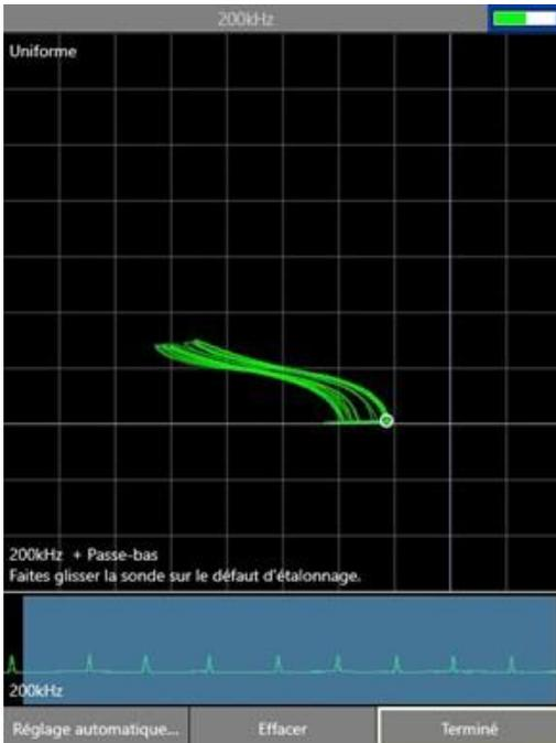
Ensuite, ajustez l'échelle en sélectionnant le bouton de menu contextuel Ajuster l'échelle. Utilisez les boutons de commande Haut/Bas et Gauche/Droite pour régler l'échelle du signal.
