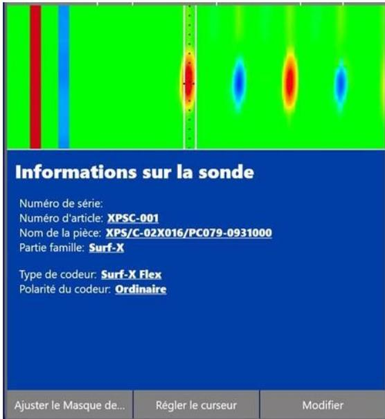
Dans cette image, le type d'encodeur est défini sur Surf-X Flex. Appuyez sur le bouton Modifier pour modifier les informations dans l'onglet Informations sur la sonde.
