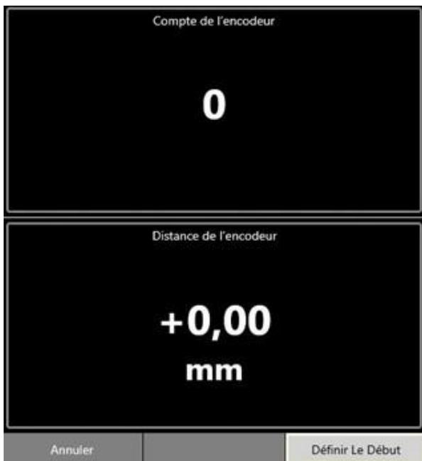
Lorsque l'Étalonnage en direct est sélectionné, la résolution du codeur est calculée en déplaçant le codeur sur une distance connue.
