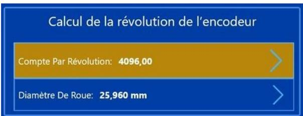
Lorsque Calculatrice est sélectionnée, le diamètre de la roue et le Nombre de comptages par révolution de l'encodeur peuvent être saisis. Le décompte du codeur par tour se trouve souvent sur la fiche technique du codeur.
